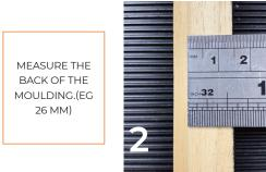
ON THE MITRE OFFSET STOP, SET THE OFFSET (26MM) ON THE BLUE SCALE AGAINST DESIRED FRAME LENGTH (EG 302 MM) ON THE YELLOW.
